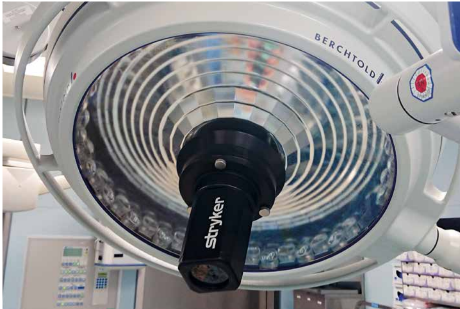
Optimaler Einblick: Bei offen-chirurgischen OPs ermöglicht eine konzentrisch in die OP-Leuchte integrierte Spezialkamera die beste Sicht Foto: Hellmuth Schulz/Universität Leipzig
